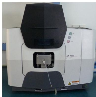
**Figura 3.** Espectrofotómetro de Absorción Atómica utilizado para el análisis de metales.
