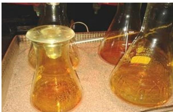
**Figura 2.** Baño de arena empleado para realizar las digestiones químicas de las muestras
