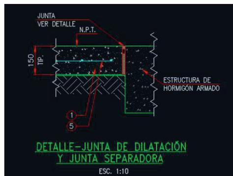
Figura 28: Detalles de Juntas de Losa
