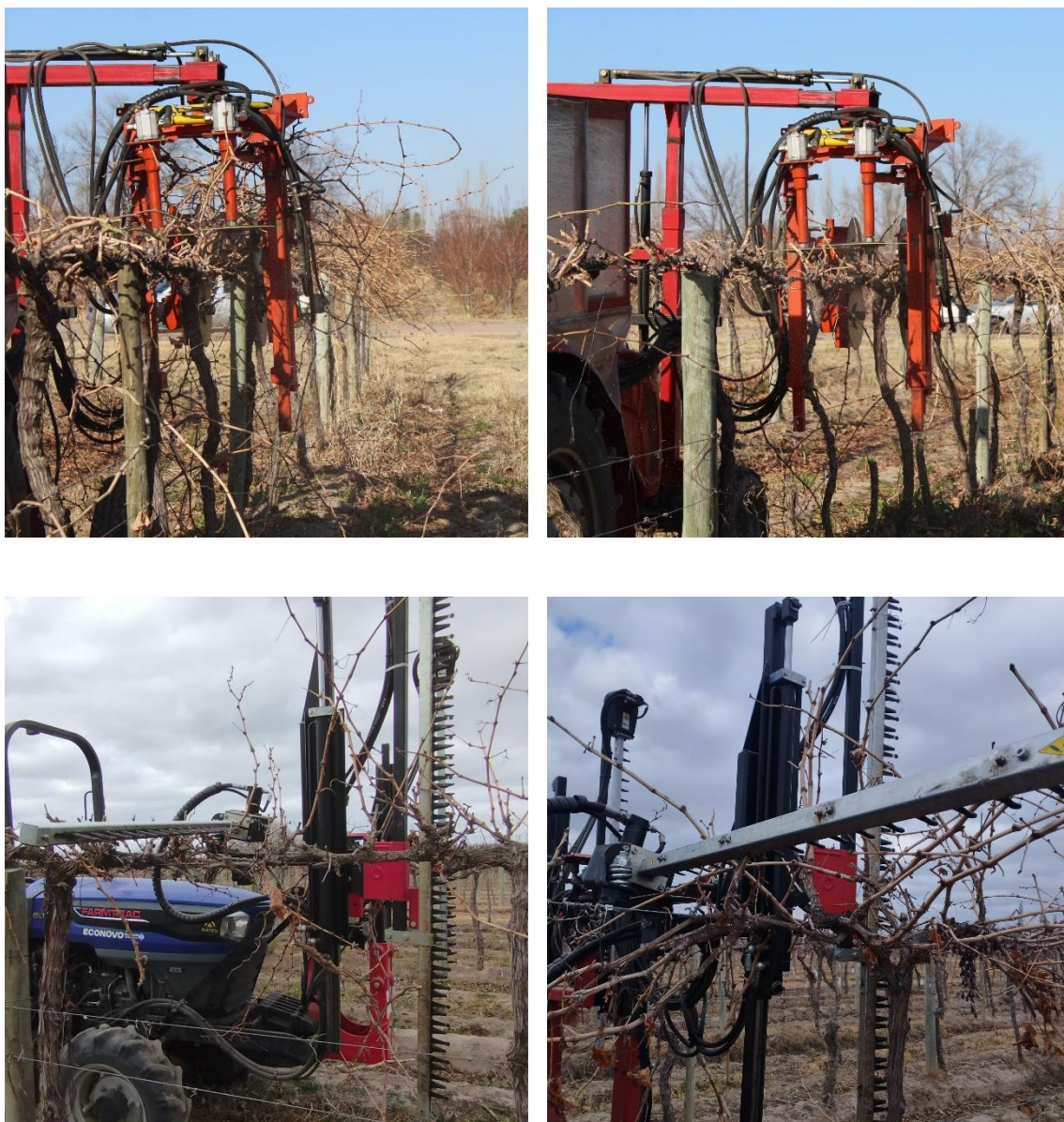
Imagen 3.1. Podadora con discos de sierras tanto en sentido de corte vertical como horizontal (dos paneles superiores). Podadora con barras tanto en sentido de corte vertical como horizontal (dos paneles inferiores) (Fotos: F.A. Barcia)
