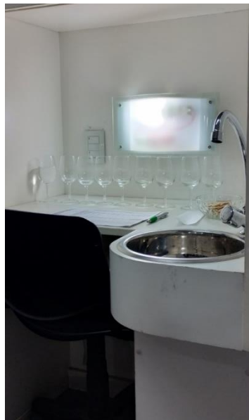
Figura 3.13. Cabina de degustación provista de copas técnicas norma ISO 3591:1977.
