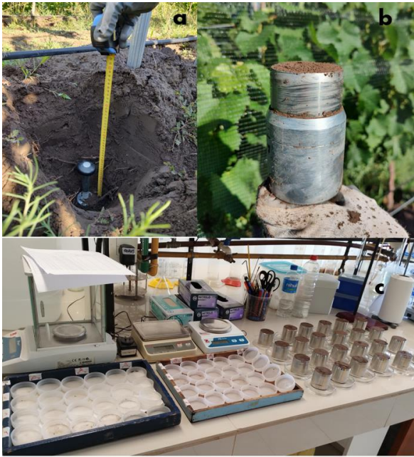
Figura 4.5. a) Localización de pozo frente a la planta. b). Cilindro calibrado con muestra enrasada. c). Registro de pesos de tapa, fondos y masa de suelo.
