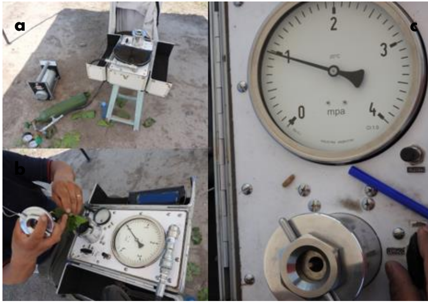
Figura 3.2. a) Cámara Scholander para medición de potencial hídrico foliar con tanques de suministro de N 2 . b) Carga de la hoja en cámara de presión c) Lectura de estado hídrico -0.98 MPa (sin estrés hídrico).
