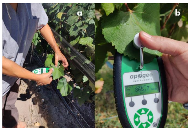
Figura 3.5. a) Lectura de concentración de clorofila con medidor portátil. b) Lectura final del instrumento de medición.
