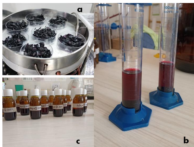
Figura 3.9. a) Hollejos liofilizados. b) Líquido de extracción de hollejos. c) Frascos con las soluciones de extracción almacenados en frascos color caramelo.
