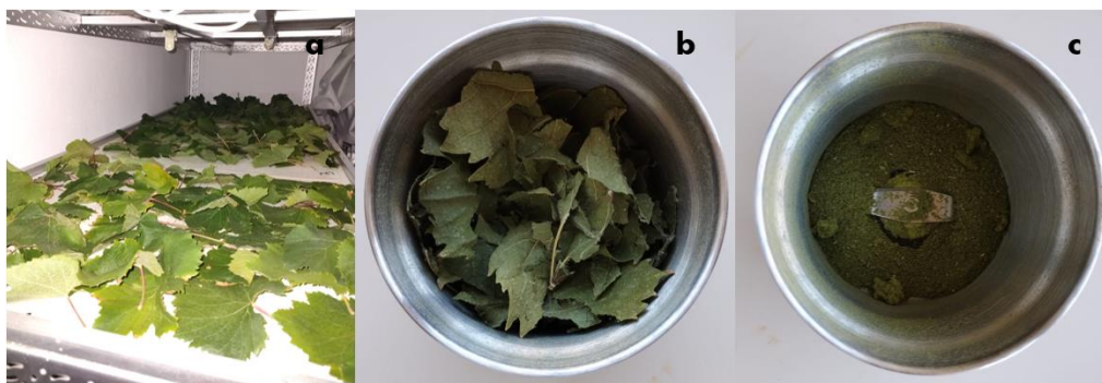
Figura 3.11. Procesamiento de limbos para determinación isotópica de carbono. a) Deshidratación de hojas. b) Hojas previo a la molienda. c) Reducción de tamaño a fino polvo.
