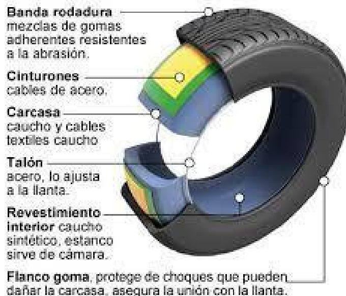
Figura 1: partes del neumático.
