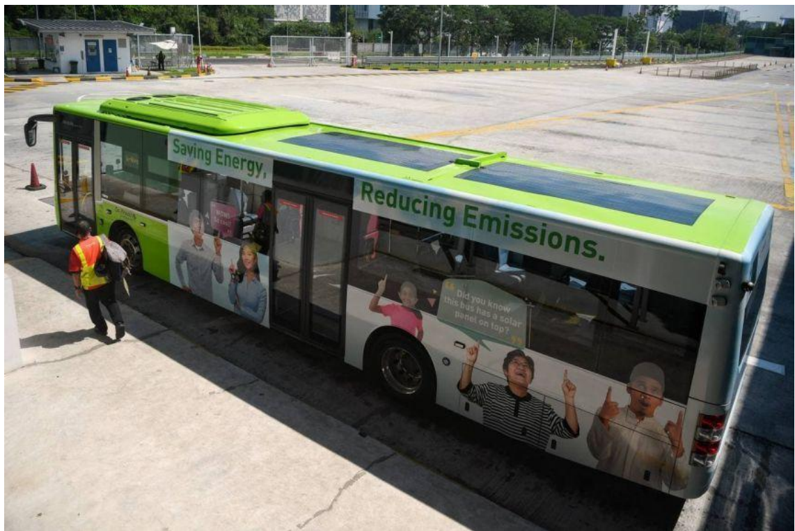
Figura 44, Buses con paneles solares en sus techos para recargar baterías
