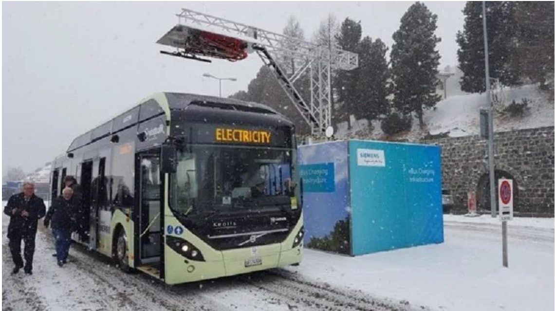
Figura 43, Bus eléctrico recargando mediante pantógrafo en las paradas
