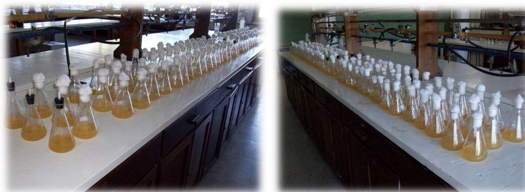
**Figuras n°5 y n°6** Erlenmeyer inoculados con LSA rehidratadas en agua glucosada
