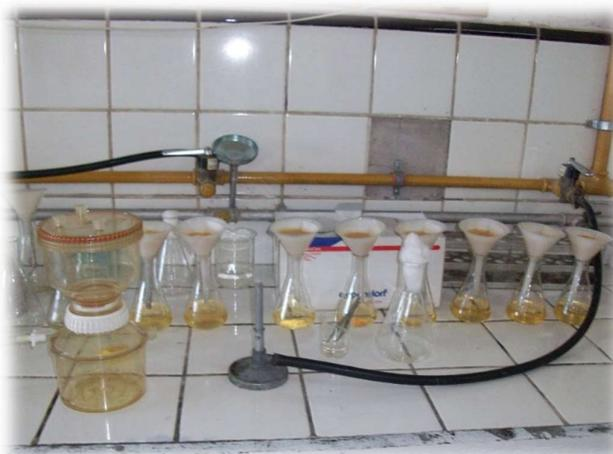
**Figura n° 9** Batería de Erlenmeyer en primera filtración y bomba de vacío
