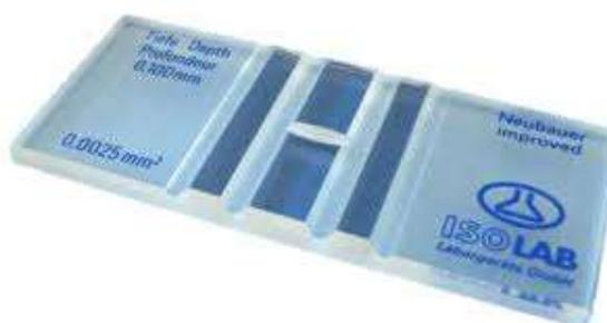
**Figura n°4** Cámara de Neubauer ([www.pro-lab.com.mx](http://www.pro-lab.com.mx))
