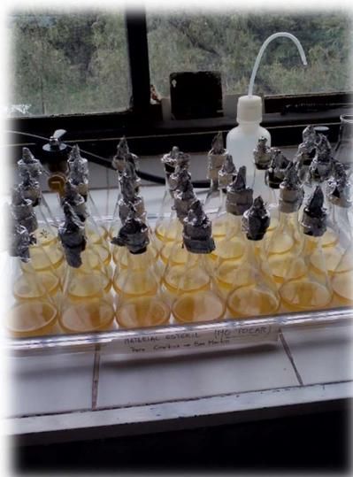
**Figura n° 7** Erlenmeyer para control de pérdida de CO<sub>2</sub>
